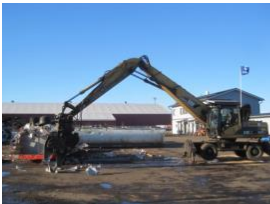
Kuva 2-13. Toiminnassa käytettävät mekaaniset leikkurit: mobiilileikkuri ja nokkaleikkuri (Kuusakoski Oy 2014, 2015).
