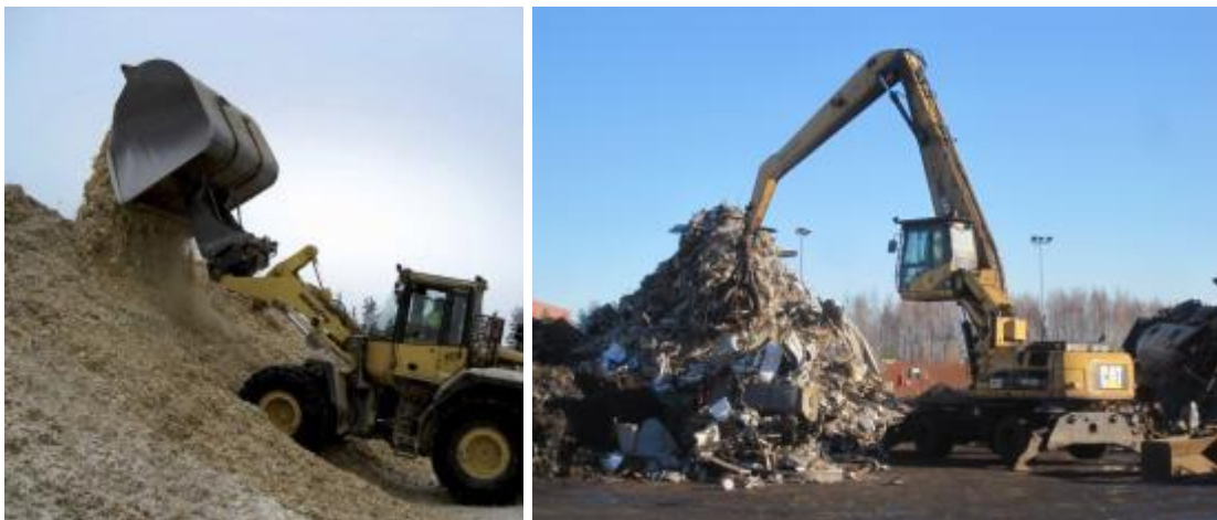
Kuva 2-11. Kauhakuormaajan ja kahmarikoneen työskentelyä (Kuusakoski Oy 2014, 2015).
