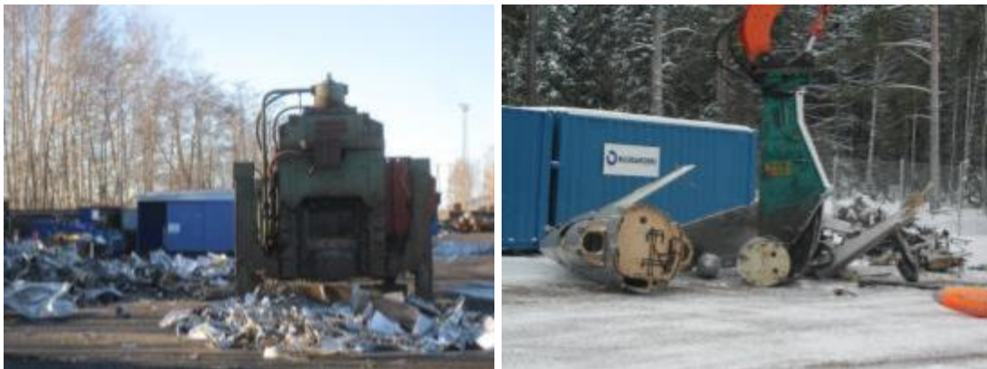
Figur 2-15. Mekaniska kapare som används i verksamheten: mobil kapare och stålsax (Kuusakoski Oy 2015).
