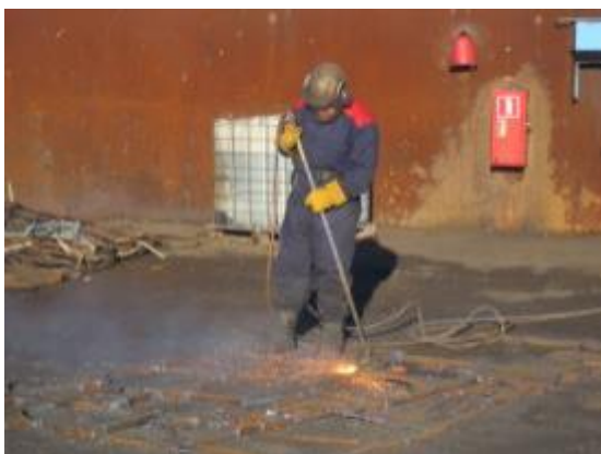
Figur 2-16. En del av det material som anländer skärbränns (Kuusakoski Oy 2014).
